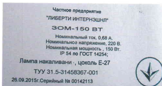
Фото 3. Маркировка заградительного огня «ЗОМ-150Вт».
