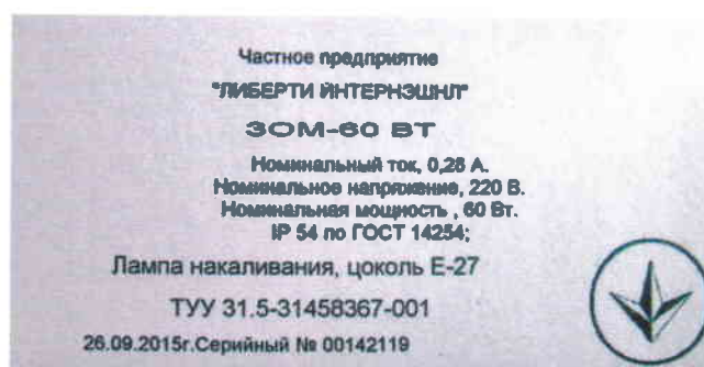
Фото 3. Маркировка заградительного огня «ЗОМ-60Вт».
